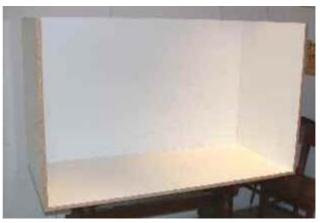
Bodenplatte verschraubt, Borungen sind ja schon vorhanden. Zuvor müssen in die Frontplatte zwei Löcher mit dem 45mm-Lochbohrer gebohrt werden. Dabei sollte man erst von einer Seite bis etwa zur Hälfte der Platte bohren und dann von der anderen Seite. Dadurch verhindert man, daß die weiße Beschichtung an der Sägekante abbricht.
