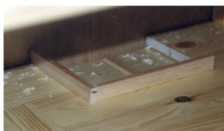
Als erstes schneiden wir aus Bastelholz ein Geländer (Höhe ca. 3cm) fürs Loch und kleben es mit Kraftkleber oder ähnlichem am Rand vom Loch fest. Unbedingt gut trocknen lassen! Es wird natürlich nur an zwei Seiten des Loches ein Geländer angeklebt. An der hinteren Seite ist ja die Rückwand und somit kommt da kein Geländer hin. Der Teil vom Geländer an der rechten Seite, da wo die Schweinchen die Rampe hoch kommen, wird mit an den Deckel befestigt.
