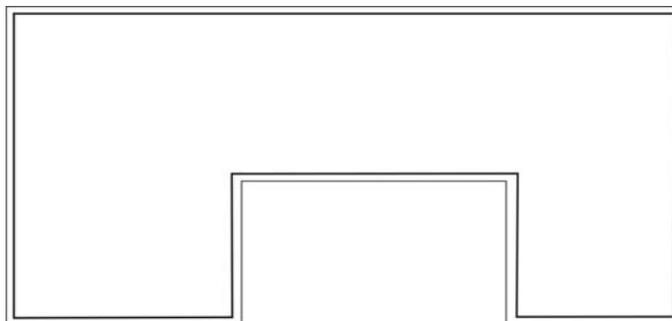
Bohren Sie jetzt mit dem 4 mm-Bohrer, im Abstand von ca. 15 cm, Löcher auf der umlaufenden Linie. Zur leichteren Montage bohren Sie mit dem 2 mm-Bohrer die Löcher vor.
