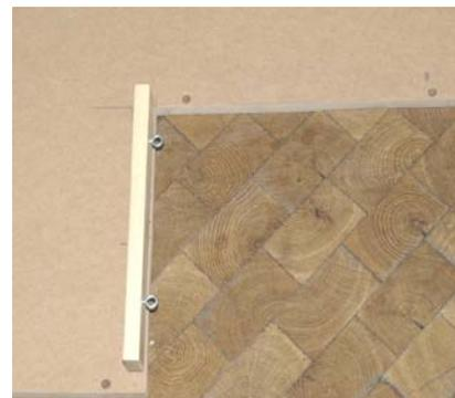
Bohren Sie als nächstes mit dem 4 mm-Bohrer die vier Löcher für die Schraubhaken, im Abstand von ca. 12 cm zur Außenkante, von außen seitlich in die Grundplatte und schrauben die vier Schraubhaken (3,8 x 50 mm) hinein.
