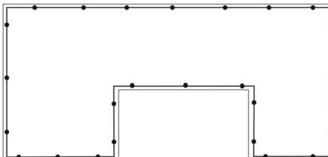
Setzen Sie jetzt die Umrangungsleisten (Position 1-6) hochkant und bündig mit der Kante auf die Grundplatte und verschrauben diese dann von unten mit der Grundplatte.
